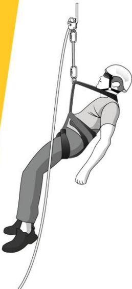
Trava-queda deslizante incluindo a linha flexível de ancoragem
